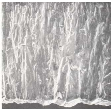
Rys.5.2.1 Zdjęcie kolumnowej struktury kryształu CVDD [GE].
