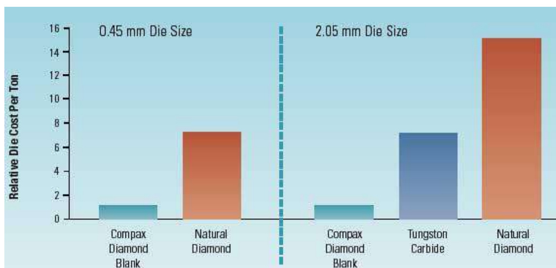
Rys. 7.2. Porównanie kosztów ciągadeł w wyrobie na 1 tone drutu w zależności od średnicy i materiału ciągadła [Diamond Innovations].
